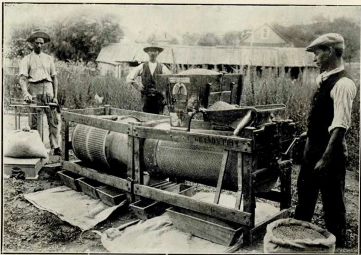
INSPECTORIA AGRICOLA. — A machina para selecção mechanica de sementes, especialmente trigo.
